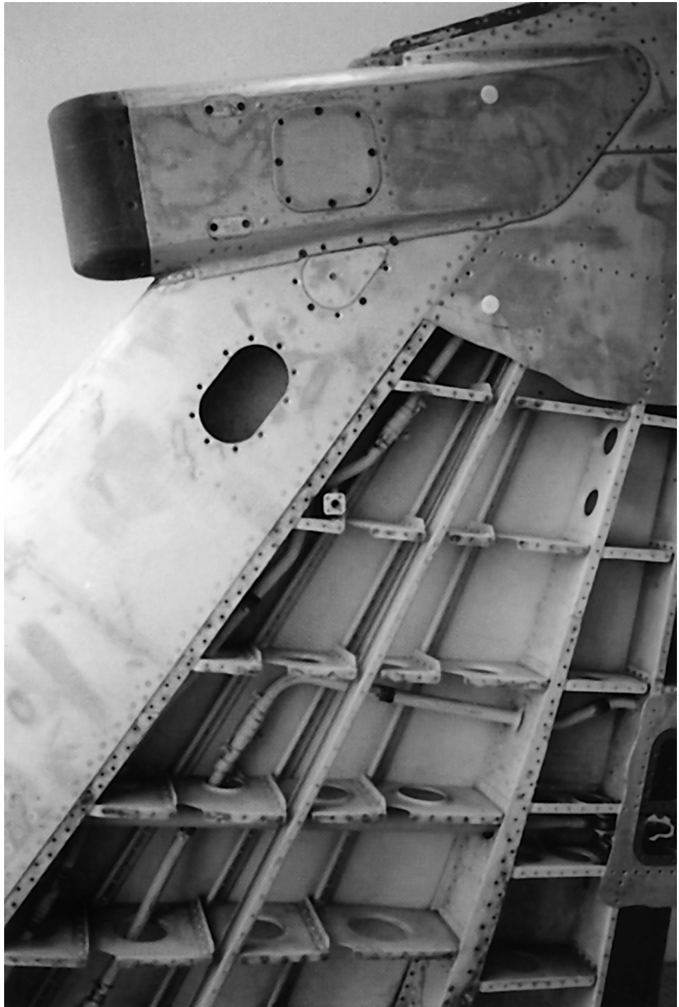
Fig 6-4 Harrier Fin Construction
